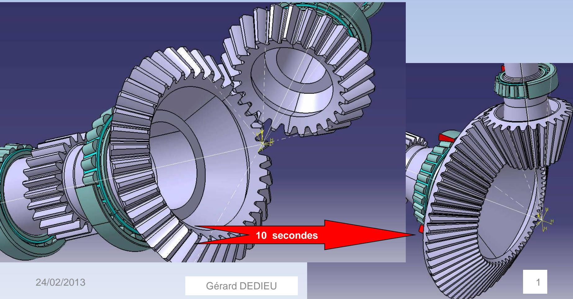
CHANGEMENT L' ANGLE DES AXES DES CONIQUES
